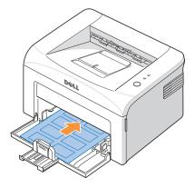
**NOTA:** Para evitar que las etiquetas se adhieran entre sí, no las coloque unas encima de otras a medida que se imprimen.
