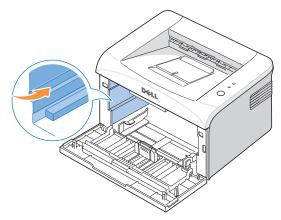
**6** Sujete el cartucho de tóner por el asa. Introduzca el cartucho en la impresora hasta que encaje en su posición.
