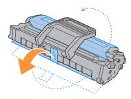
5 Coloque la ranura del cartucho dentro de la impresora, una en cada lado.
